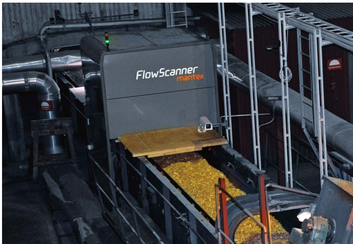
Mantex Flow Scanner mäter på träflisflödet på transportbandet in i kokaren och ger i realtid ett värde på torrmassflödet. Det möjliggör bättre styrning av kokprocessen som kan förbättra både processutbytet och produktkvaliteten. För ett medelstort pappersmassabruk bedöms den totala potentialen i förbättrad lönsamhet vara 25-140 miljoner kronor per år.
